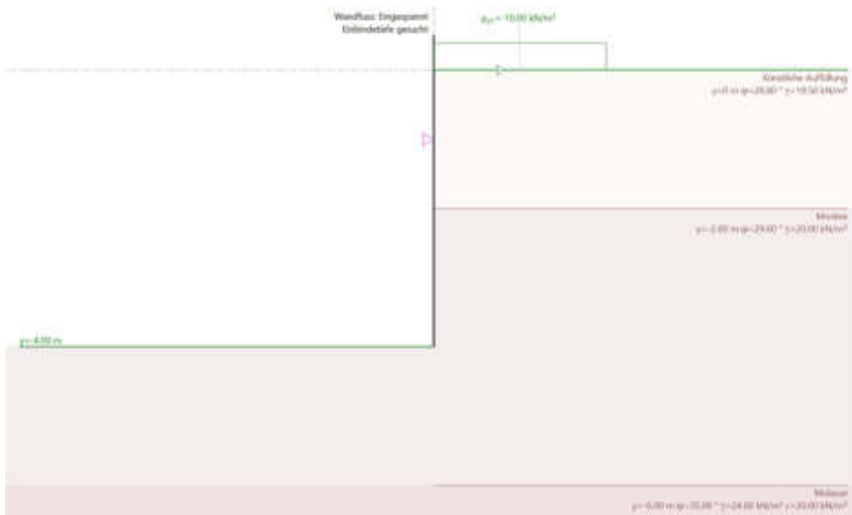
Abbildung 4: Einwirkungen: Auflast Perron (+50 cm Erdauflast)
